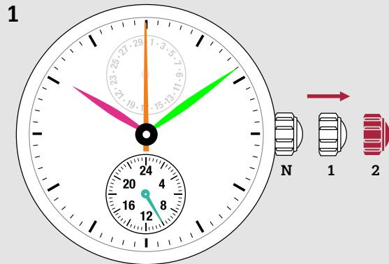
1. Saque la corona hasta la posición del segundo clic cuando la manecilla de los segundos esté en la posición de las 12 horas.
