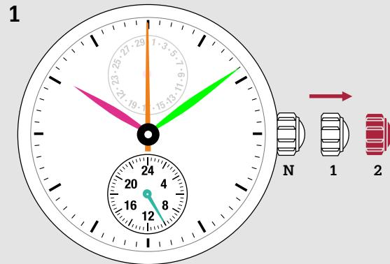
1. Ziehen Sie Krone bis zum zweiten Klick heraus, wenn die zweite Hand an der 12-Uhr-Position liegt.
