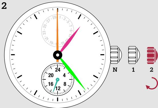
2. Tournez la couronne pour régler l'aiguille des heures et l'aiguille des minutes à l'heure souhaitée (vérifiez que le réglage AM/PM (matin/soir) est correct)
