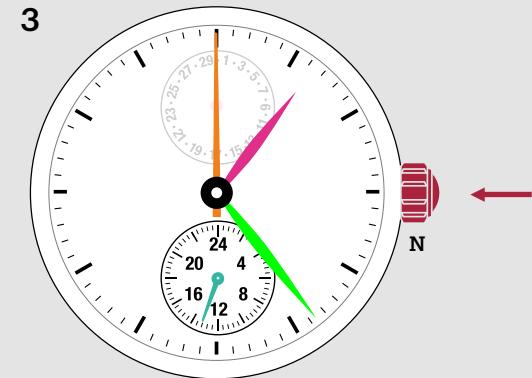
3. Empurre a coroa de volta para a posição normal simultaneamente com o sinal horário.
