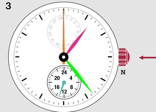
3. Empuje la corona de nuevo hacia la posición normal según la señal horaria.
