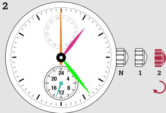
2. Drehen Sie die Krone, um den Stundenzeiger und den Minutenzeiger auf die korrekte Zeit umzustellen (prüfen Sie nach, dass AM/PM korrekt eingestellt worden ist)
