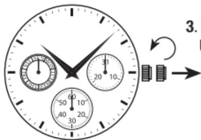
3. Stellen Sie das Datum durch Drehen der Krone gegen den Uhrzeigersinn ein (Schnellumstellungsfunktion).
