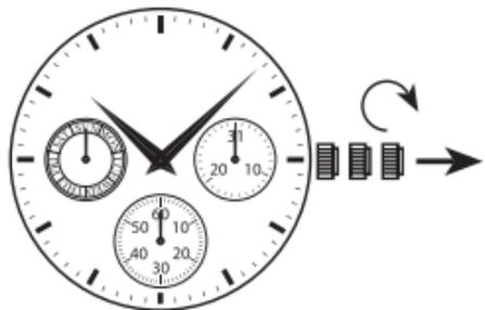
1. Tirez la couronne vers l'extérieur jusqu'au deuxième clic, lorsque la petite trotteuse se trouve sur 12h pile. Elle s'arrêtera immédiatement et vous pourrez bouger les aiguilles de l'heure et des minutes en tournant la couronne.
