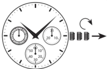
1. Ziehen Sie die Krone bis zum zweiten Klicken heraus, wenn der Sekundenzeiger sich auf der 12 Uhr Position befindet.
