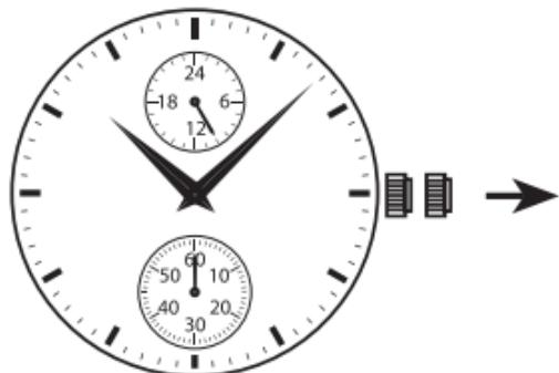
**2.** Drehen Sie die Stunden- und Minutenzeiger durch Drehen der Krone weiter. (Beachten Sie, dass der 24-Stundenanzeiger korrekt eingestellt ist).
