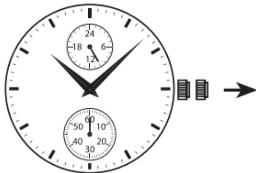
2. Portare avanti le lancette delle ore e dei minuti ruotando la corona. (Verificare che la lancetta delle 24 ore sia impostata correttamente).
